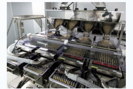
千葉工場サプリメントの充填機
