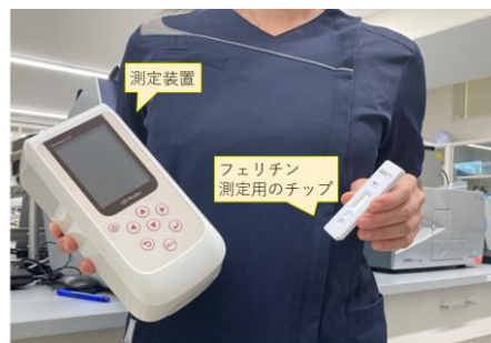
図4：持ち運び可能なフェリチンの簡易測定装置
