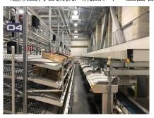
人の手で機器の上に製品をセット。その下を集品コンテナが通過した際に自動で 製品をコンテナに投下してピッキング
