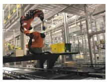
製品をピッキングして集品コンテナに 自動で投入
